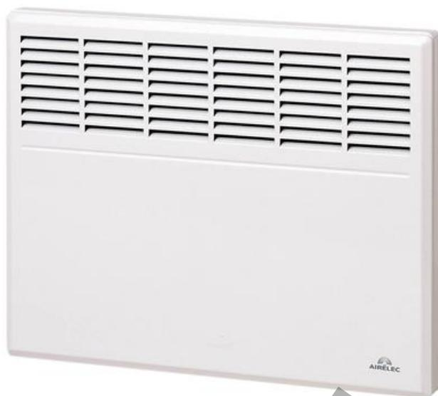
Електрически конвекторни радиатори за монтаж на стена. Работят с естествена конвекция и са абсолютно безшумни. Вграденият електромеханичен терморегулатор поддържа постоянна температура в помещението и понижава енергийните разходи. Специалната конструкция на решетката насочва топлия въздух надолу и подобрява топлообмена. Нагревателят е тръбен с алуминиево оребряване и голяма повърхност.
